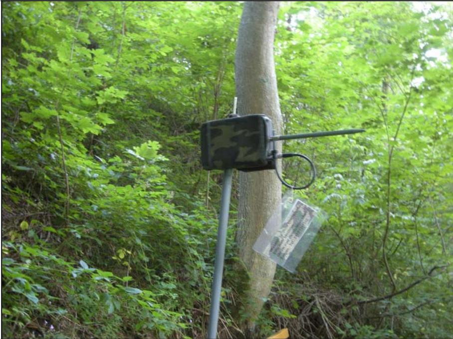
Abbildung 2: Automatisches Aufzeichnungsgerät (batcorder der Fa. ecoobs)
