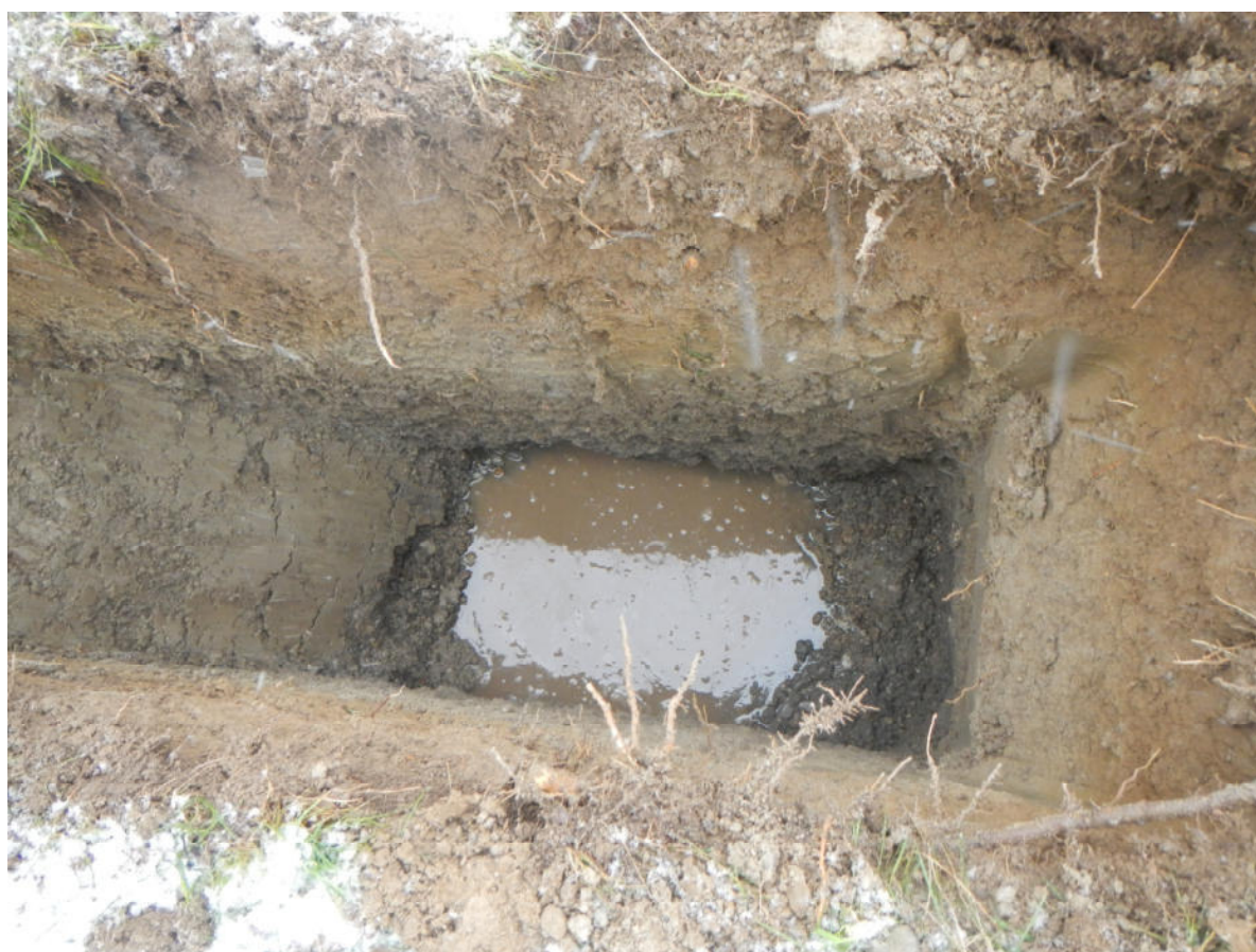
Foto 6: Baggerschurf BS 6 am 27.01.2021, Grundwasserspiegel bei 1,90 m u. GOK
