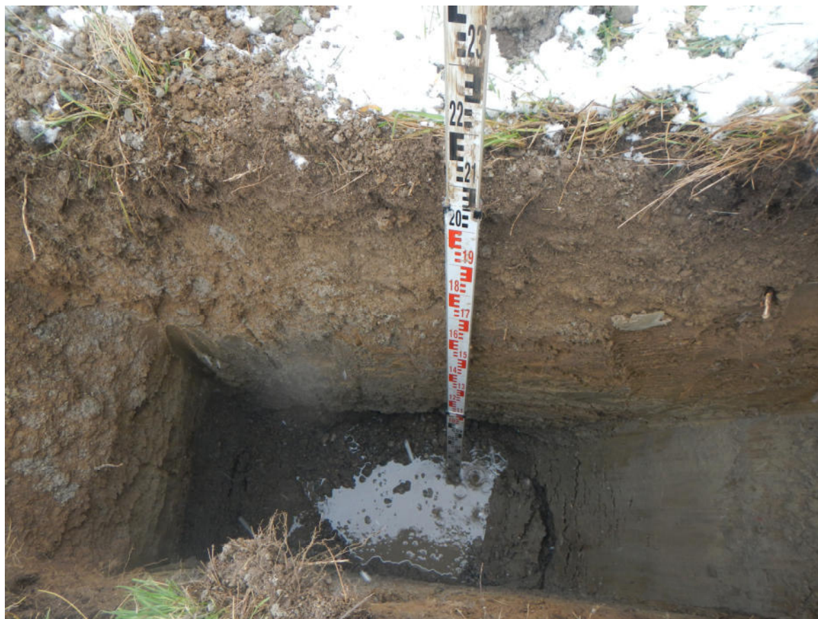
Foto 7: Baggerschurf BS 7 am 27.01.2021, Grundwasserspiegel bei 2,0 m u. GOK
