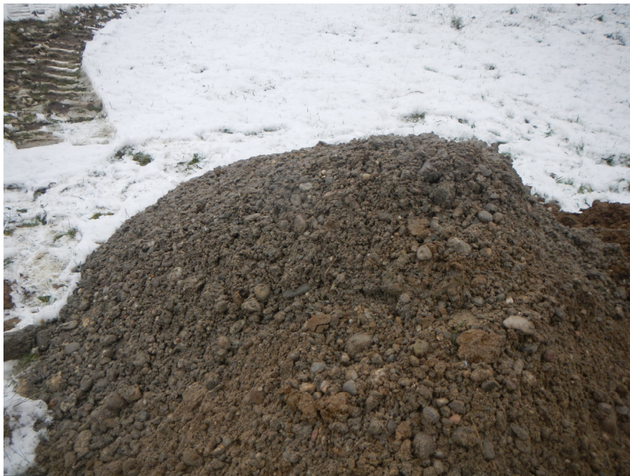
Fotos 5+6: Flurstücke Nr. 3003 und Nr. 4109 Nonnenweier, Baggerschurfe am 27.01.2021 grundwasserführende Rheinkiese auf Foto 6 noch Anteile von verlehnten Kiesen
