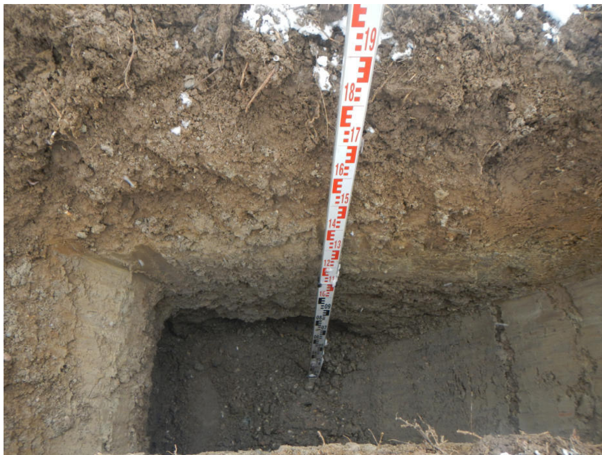
Foto 9: Baggerschurf BS 9 am 27.01.2021, Grundwasserspiegel bei 1,90 m u. GOK
