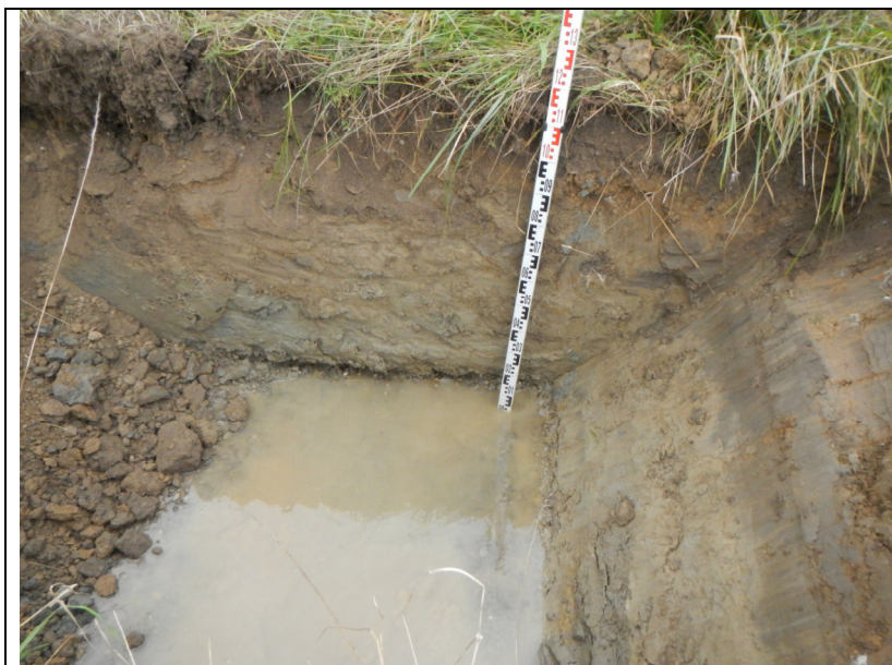
Foto 1: BG Ziegelgarten, Nonnenweier, 10.09.2020 Baggerschurf BS 1 GW-Stand bei 1,2 m u. GOK (= Kiesoberfläche)
