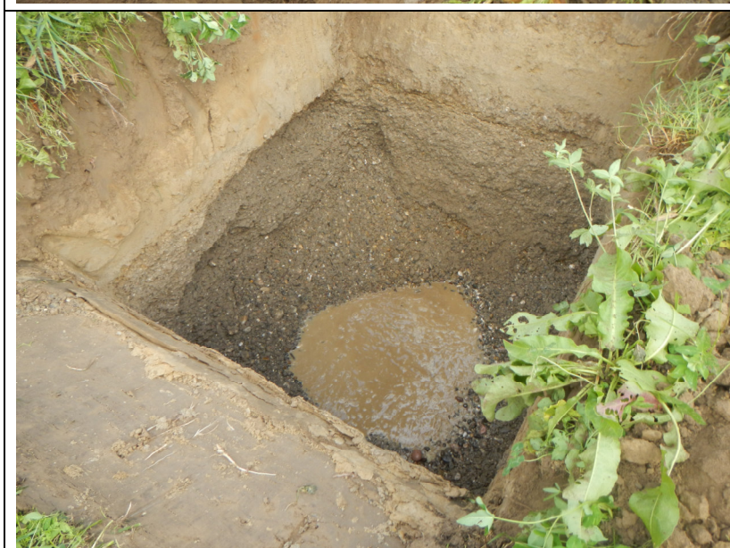
Foto 3: BG Ziegelgarten, Nonnenweier, 10.09.2020 Baggerschurf BS 3 GW-Stand bei 2,3 m u. GOK (= 1,6 m u. Kiesoberfläche)
