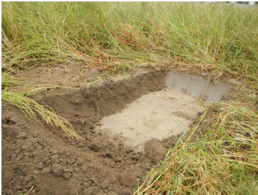
Fotos 1+2: BG Ziegelgarten Nonnenweier, Baggerschurfe am 10.09.2020 Organisches Oberbodenmaterial
