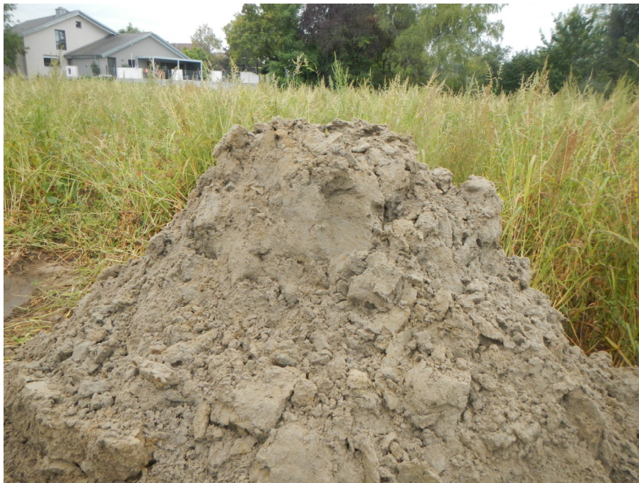
Fotos 5+6: BG Ziegelgarten Nonnenweier, Baggerschurfe am 10.09.2020 Hellgraue Sande über den grundwasserführenden Rheinkiesen
