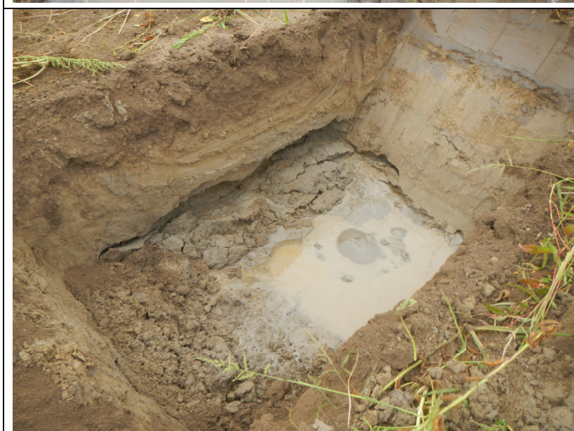
Foto 2: BG Ziegelgarten, Nonnenweier, 10.09.2020 Baggerschurf BS 2 GW-Stand bei 0,9 m u. GOK (= Kiesoberfläche)
