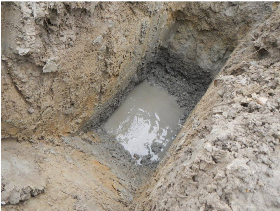
Grundwasserführende graue Kiese in Schurf BS 6
