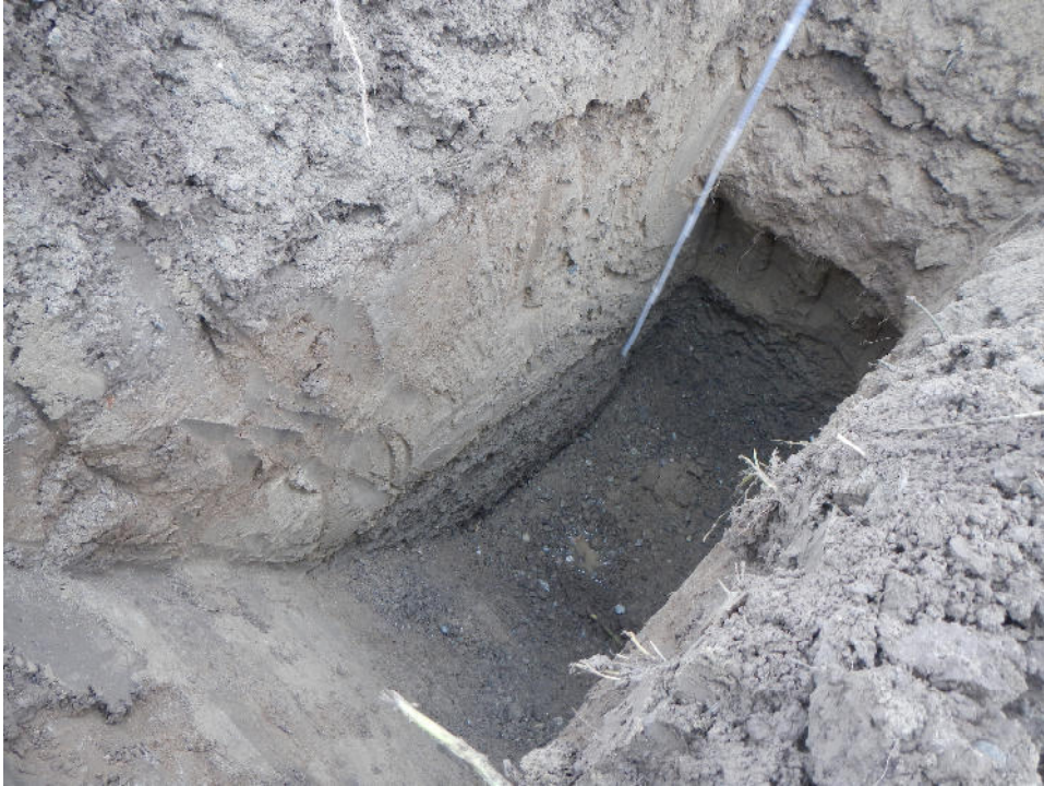
Hellgraue Auelehmschichten in Baggerschurf BS 5
