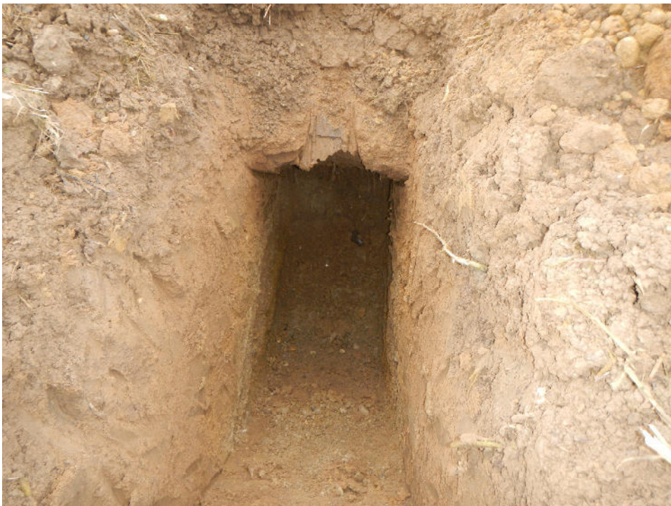
Hellbraune Auelehmschichten unter dem Oberboden in Schurf BS 1
