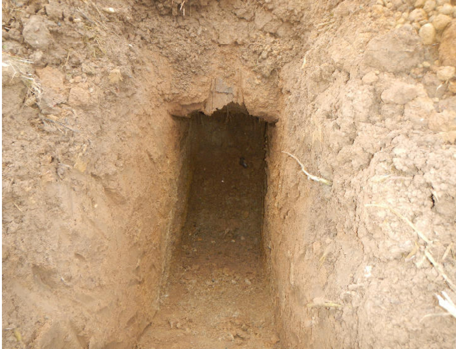
Braune Kiesschichten („Roter“ Kies) mit hohen Schluffanteilen in Schurf BS 1
