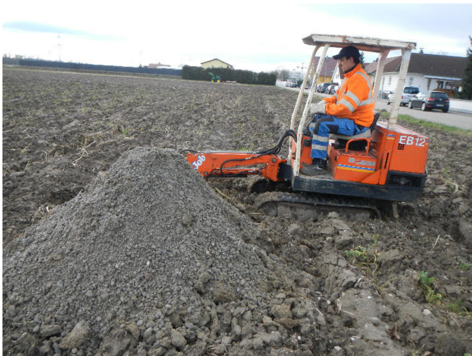
Graue Kiese aus dem Schurf BS 2
