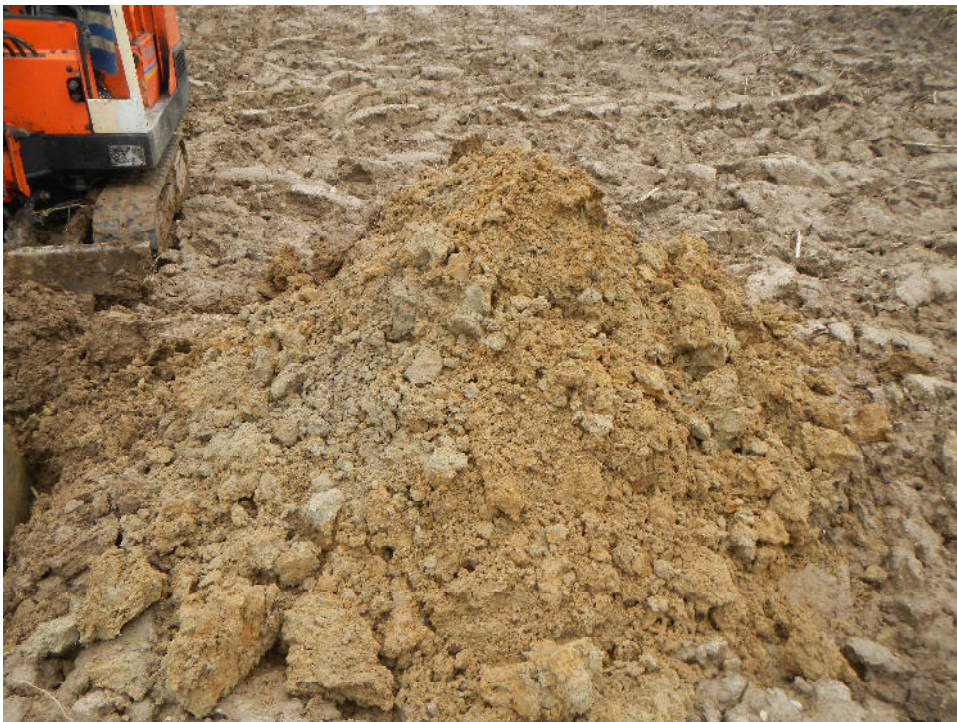
Gelbbraune Auelehmschichten aus dem Schurf BS 6
