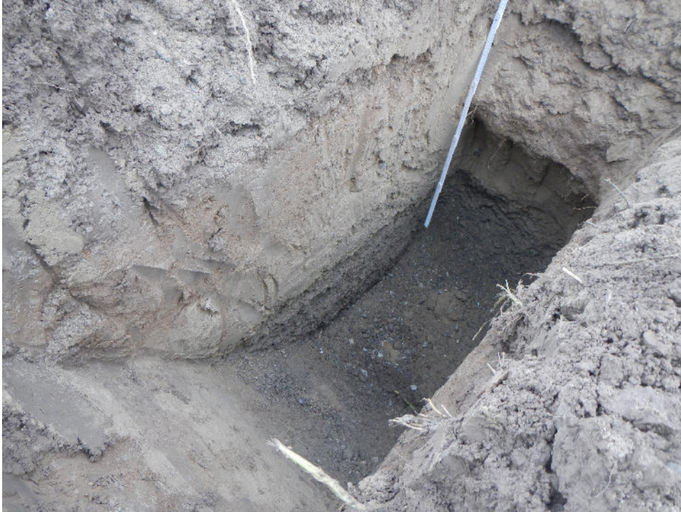
Graue Kiesschichten in Schurf BS 5
