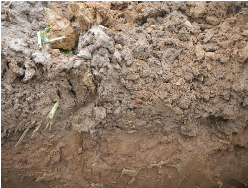
Organischer Oberboden mit Wurzelresten (Mais) in Schurf BS 1
