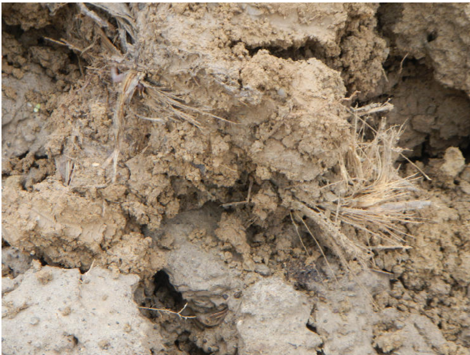
Oberboden mit Wurzelresten Mais in Schurf BS 6
