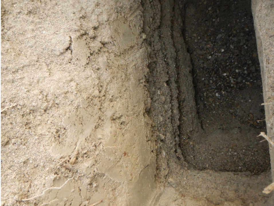
Rheinkiese bei 1,8-2,0 m u. GOK, nicht grundwasserführend in Schurf BS 1
