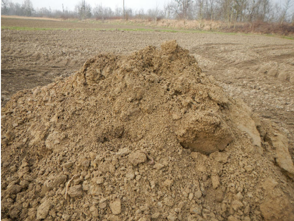
Stark feinsandiger Schluffe in Baggerschurf BS 5
